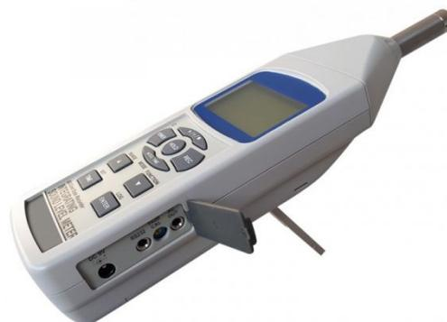
Il permet de faire des enregistrements du niveau sonore en fonction du temps, directement au format tableur .xls sur carte SD (non incl.), sans avoir besoin de logiciel supplémentaire. Avec sa fonction intégrateur, il vous permet de connaître également les niveaux acoustiques et "quantités" de sons perçus en unité Leq, SEL ou dB-SPL. Le sonomètre idéal pour la mesure environnementale, les conditions de travail en milieux bruyants, nuisances sonores...
